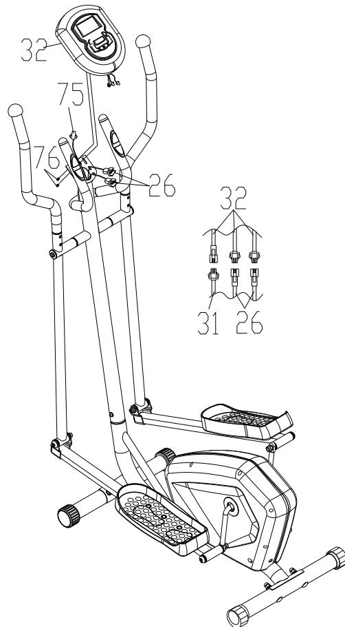
Соедините провода консоли (32) с проводами (31,26). Затем закрепите консоль (32) на стойке (2).
